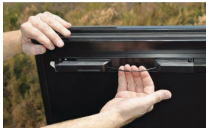
ACCESS RELEASE CABLES ON EITHER SIDE
